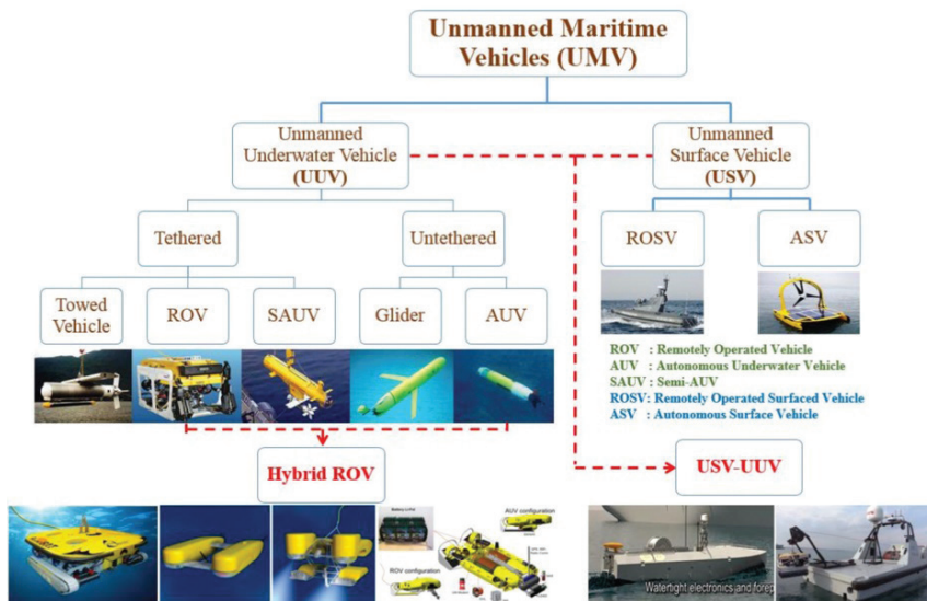
Hình 1. Phân loại thiết bị, phương tiện thủy không người lái [8]
